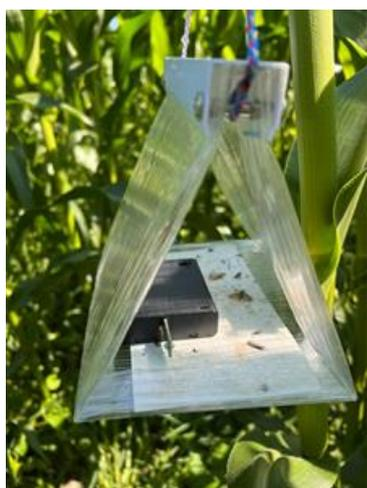
**Светодиодная клеевая ловушка «Дельта» конструкции ВИЗР**
